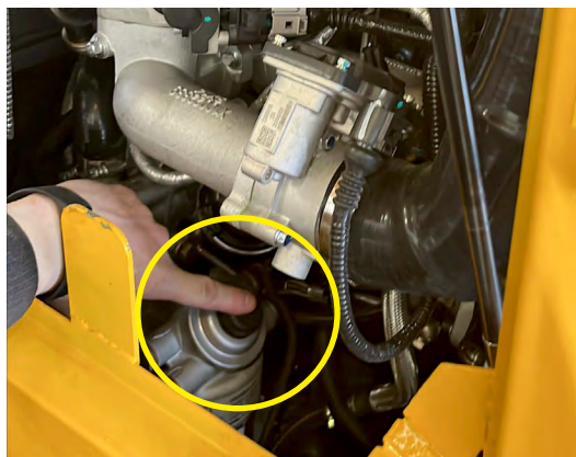
Handpump. Används vid bränslestopp.
